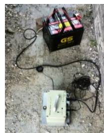
图 2 微动观测系统 Fig.2 Microtremor measurement system
